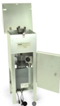
Figuur 2: Foto van de bemonsteraar. Omgevingslucht wordt via de TSP-bemonsteringskop bovenaan aangezogen, door een filter en PUF waar respectievelijk stofvormige deeltjes en gasvormige stoffen op achter blijven.
