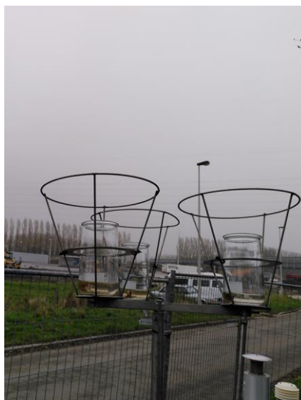
Figuur 5: Opstelling met drie Bergerhoff-neerslagkruiken in een houder met vogelscherm op paal.
