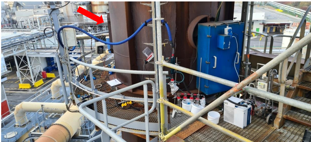
Figuur 1 : Meetpunt en gemodificeerde EPA OTM-45 opstelling schouwmeting op de DTO2 bij Indaver,
